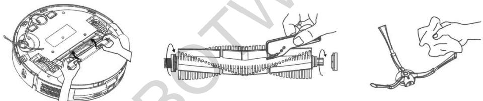
Hlavní středový čistící kartáč vyjměte stisknutím obou úchytek na krytu kartáče. K odstranění vlasů zamotaných do hlavního kartáče použijte čisticí nástroj. Udržujte středový čistící kartáč bez většího množství vlasů, prachu, bavlny apod. Zkontrolujte dle intenzity znečištění, minimálně jednou týdně, boční čistící kartáč společně s otvorem pro nasávání vzduchu a odstraňte z něho namotané vlasy a další nečistoty.
