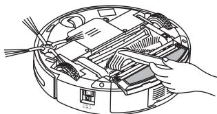
**Demontáž a montáž levého/pravého a předního kolečka****Demontáž a montáž levého/pravého kolečka**
