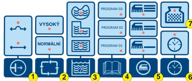
1. **Auto detekce:** tato funkce chrání robota před nárazem do překážek v bazénu, jako jsou vypoušťecí otvory, schody, žebříky atd. Stiskněte toto tlačítko pro volbu jedné z následujících možností:
