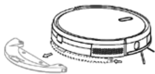
VR2100 modell - Felakasztható víztartály
