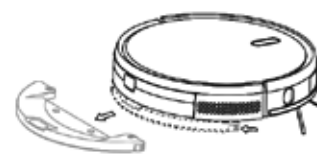
Modello VR2100 - Contenitore per l'acqua sospeso
